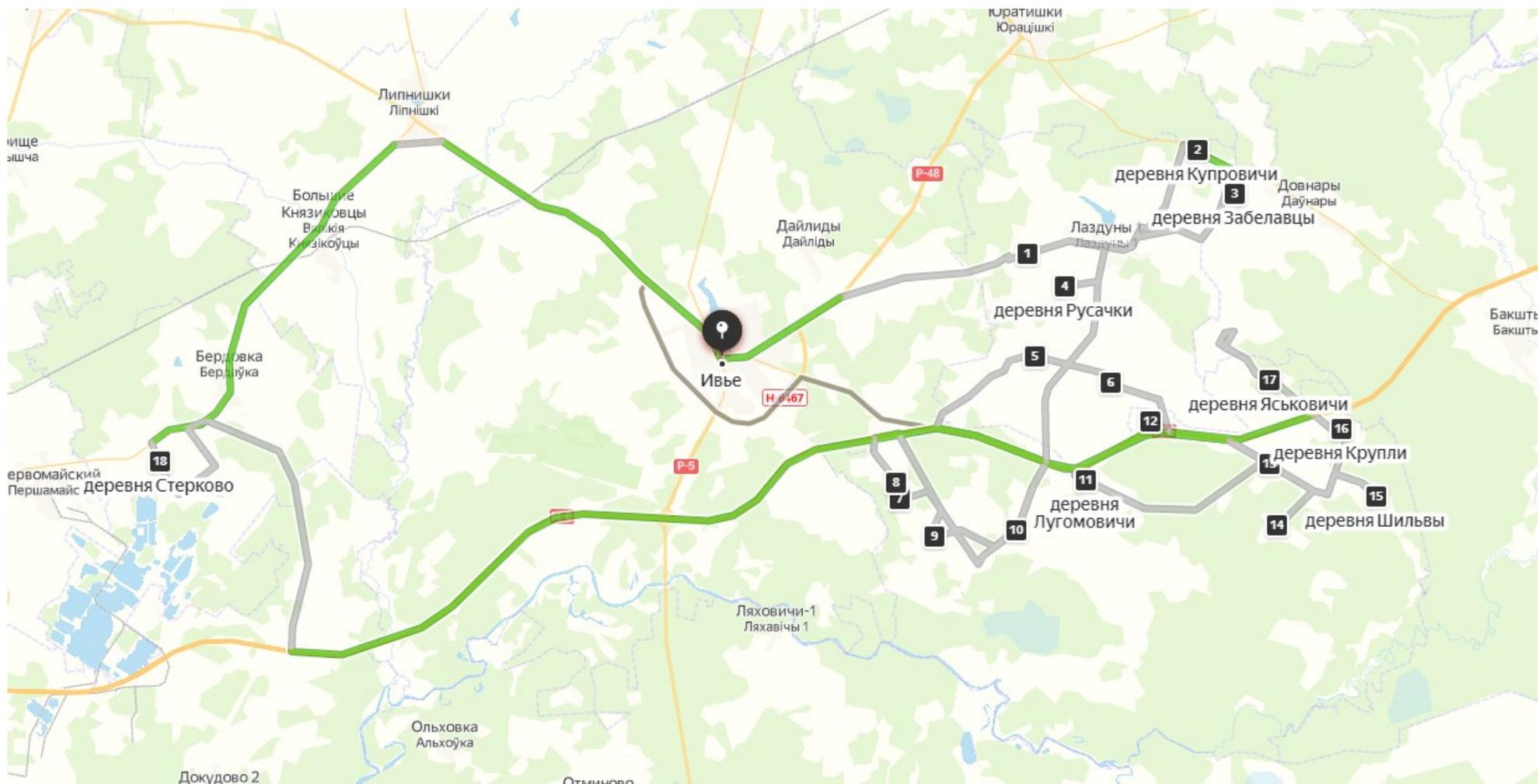
Рисунок 6 – Маршрутный график сбора и удаления ТКО машина 1 2я и 4я ср.
